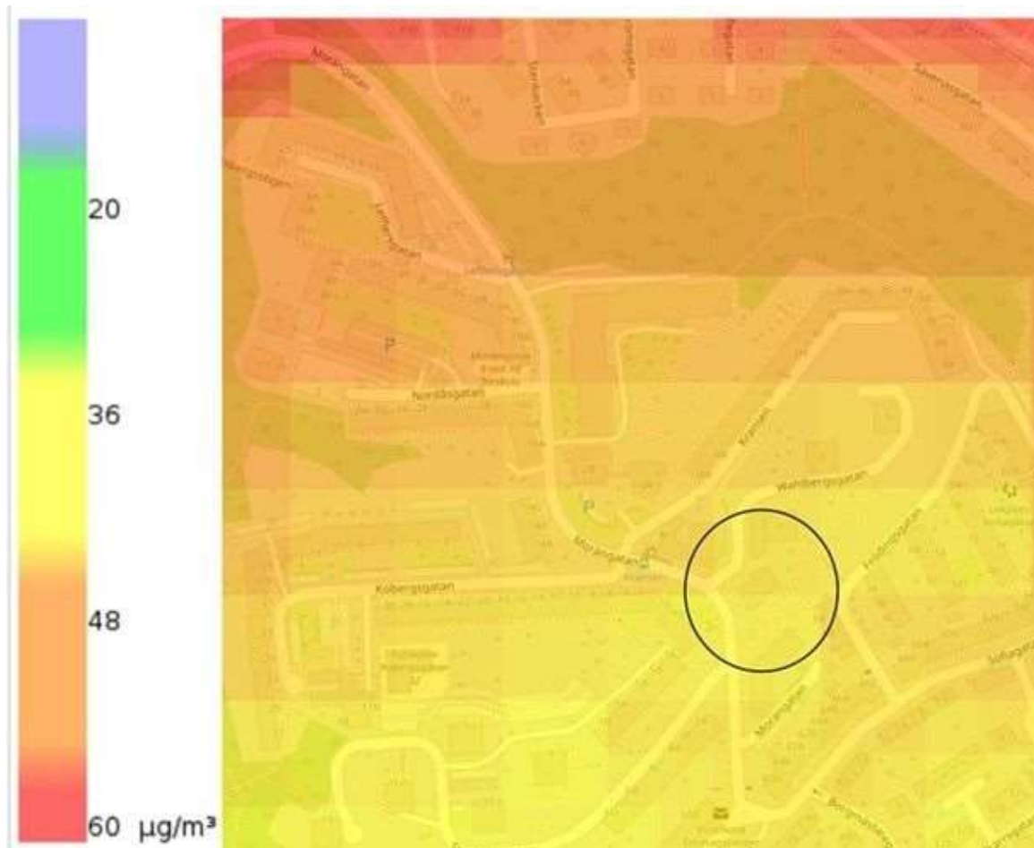
Figur 23: I figuren visas beräknade halter för år 2019. Miljö kvalitetsnormens gränsvärde för 98-percentilen av dygnsmedelvärden är 60 \mu\text{g}/\text{m}^3 .
